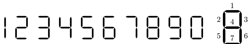
Obr. 6. Dekadické číslice na displeji se sedmi segmenty (ilustrace k experimentům DČ a VNČ). Vpravo je znázorněno číslování segmentů – segmentu č. 1 odpovídá prediktor X_1 , atd.
